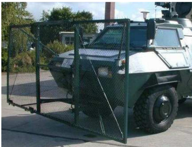
SW4 mit sogenanntem „Räumgitter“.
