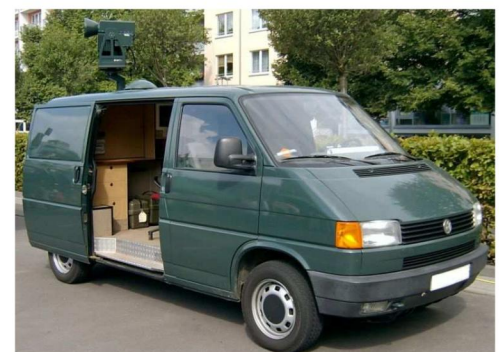
VW T4 mit Nachtsichtgerät auf dem Dach zur Grenzüberwachung.
