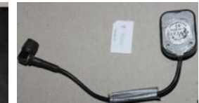
Antenne GPS et carte SIM
