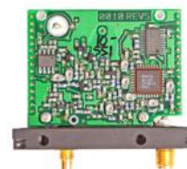
Module permettant la transmission par ondes radio
