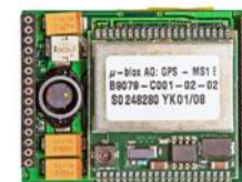
Module fournissant le signal GPS
