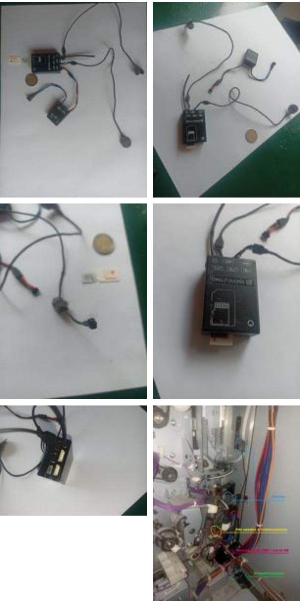
Bleu : micros ; jaune : fils soudés à l'alimentation ; rose : boîtier carte SIM + carte SD ; vert : transformateur.
