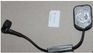
Antenne GPS et carte SIM
