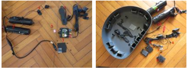
1 : unité de contrôle ; 2 : batteries ; 3 : antenne GPS ; 4 : microphone ; 5 : les micros connectés au dispositif d'écoute ; 6 : dispositif d'écoute démonté ; 7 : carte SD.
