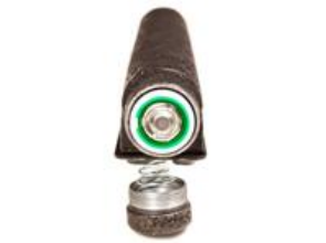
Bout du lot de batteries
