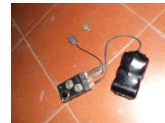
En sens antihoraire à partir d'en haut : dispositif avec antenne, SIM et carte mémoire ; GPS ; câbles d'alimentation.
