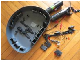
2 : les deux batteries du dispositif d'écoute ; 4 : les micros connectés au dispositif d'écoute ; 6 : dispositif d'écoute démonté ; 7 : carte SD.
