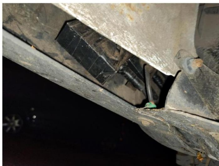
Bild 2.1: GPS Tracker an Seitenschwelle vom Auto
