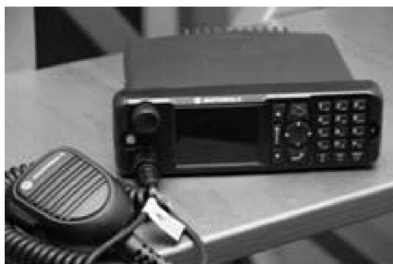
Aktuell verwendete TETRA-Geräte: Fest im Auto verbautes Handgerät; MRT (Basisgerät) von Motorola; HRT (Handgerät) von Sepura
