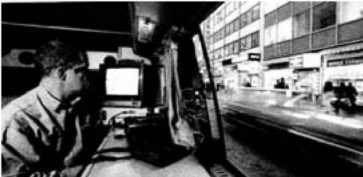
Beamter im Inneren eines getarnten Transporters (Aufriss). Das große Fenster rechts ist nach außen verspiegelt oder stark abgedunkelt
