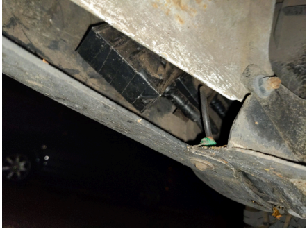
Une balise GPS retrouvée sous un véhicule à Berlin, en Allemagne, en août 2022. 43
