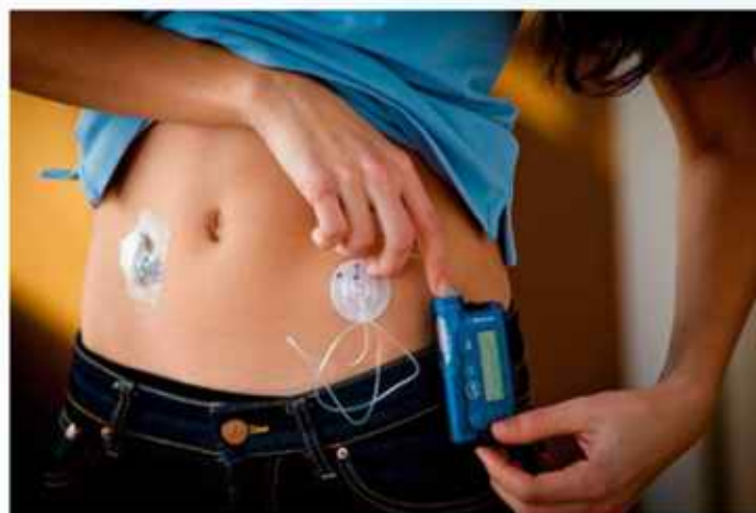
Nowoczesną metodą leczenia cukrzycy typu I jest stałe podawanie insuliny za pomocą pompy insulinowej.
